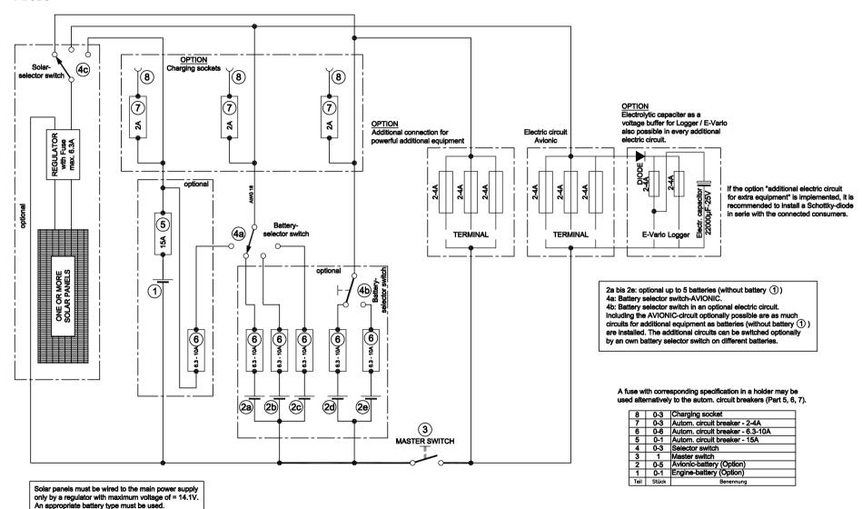
**WIRING DIAGRAM - AVIONIC**
