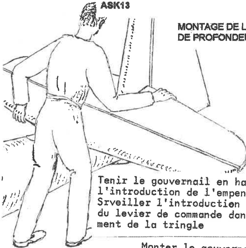
Tenir le gouvernail en haut lors de l'introduction de l'empennage. Surveiller l'introduction du roulement du levier de commande dans le logement de la tringle
