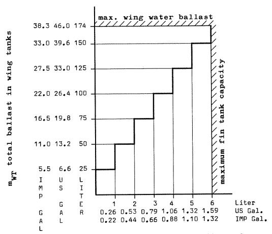
$m_{\overline{FT}}$  water ballast in fin tank
