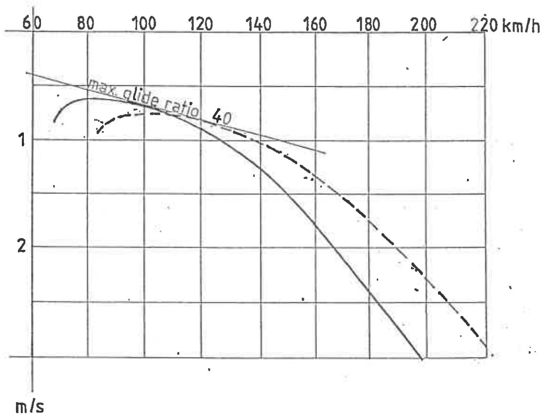
Ces mesures ont été effectuées avec un planeur ayant les ailes parfaitement propres. Les insectes et la pluie détériorent considérablement les performances et les qualités de vol.
