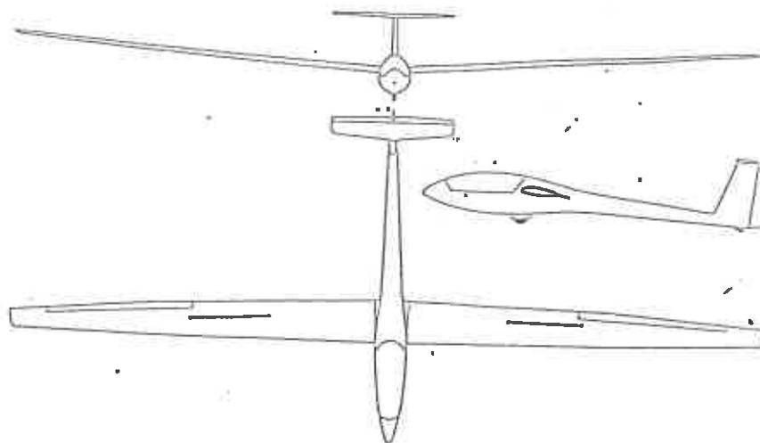
Le planeur **LS4 -a** est un planeur de classe standard, train rentrant amorti et empennage en T. Il comporte des aérofreins d'extrados.
