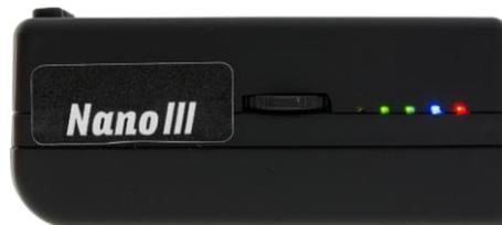
La coque extérieure est fabriquée en plastique ABS. Sur sa partie gauche, il y a un bouton à bascule et 5 LEDS indiquant le statut du NANO<sup>3</sup>.
