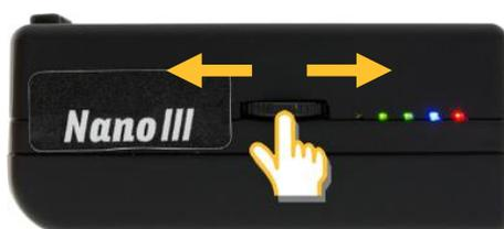
Appuyez dessus pour allumer le NANO<sup>3</sup>. Appuyez ou basculez le bouton pendant quelques secondes pour éteindre le NANO<sup>3</sup>. En vol, appuyez ou basculez le bouton rapidement pour créer un événement. Celui-ci sera enregistré et le NANO<sup>3</sup> enregistre alors 30 positions GPS avec des intervalles de 1 seconde.
