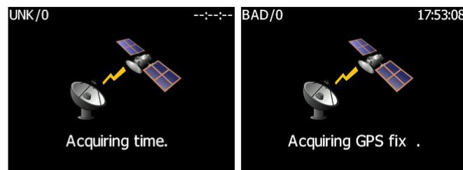
Quand le NANO<sup>3</sup> enregistre un point GPS, il passe sur la page GPS Info. L'utilisateur peut à tout moment annuler cette page en appuyant sur un bouton quelconque. L'acquisition de la position GPS peut prendre entre quelques secondes et quelques minutes, cela dépend de la position des satellites et celle du NANO<sup>3</sup>. Le NANO<sup>3</sup> a un capteur GPS très précis qui peut acquérir un signal GPS dans une pièce.
