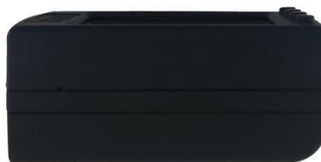
Sur le côté droit il y a un petit trou avec un bouton reset. Utilisez une pointe (un trombone par exemple) pour presser ce bouton et effectuer un reset du Nano<sup>3</sup>. En conditions normales, ce bouton ne devrait jamais être utilisé.
