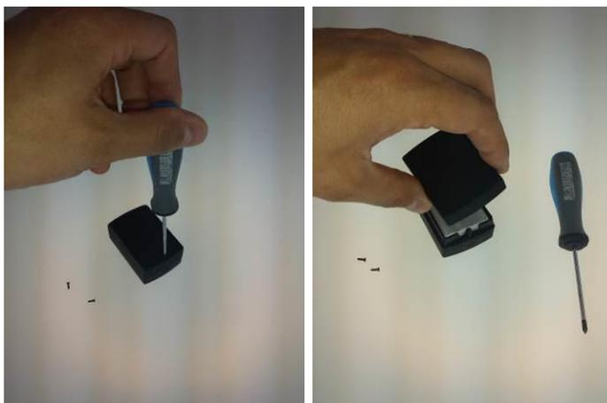
Insérer une nouvelle batterie Nokia Lithium-Ion 3310 en faisant attention à bien la placer au niveau des contacts. Refermer la coque et revisser.
