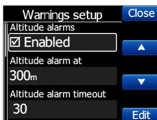
Les alertes d'altitude et les alertes Flarm peuvent être paramétrées dans ce menu.
