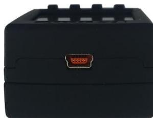
A l'arrière se trouve un connecteur mini USB, utile pour transférer les fichiers de vols et les données. Nanoconfig est préinstallé sur le disque SSD interne. Ce logiciel est utilisé pour effectuer des déclarations de vols et changer les paramètres du NANO<sup>3</sup>. Les déclarations de vol peuvent également être téléchargées en utilisant un câble série ou le Bluetooth. (Voir chapitre 4.9 Pour plus de détails).
